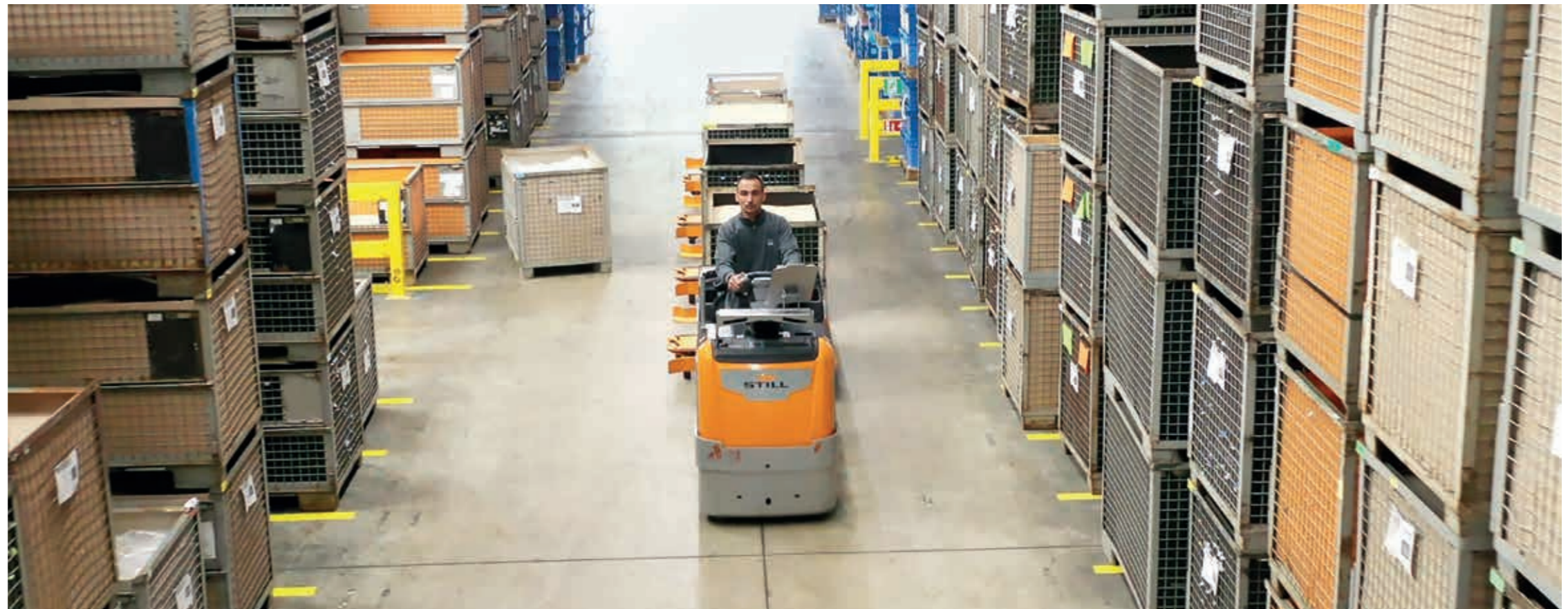
Zug um Zug zur verkehrsberuhigten Zone: Der neue Routenzug verschlankt die Produktionsversorgung.
