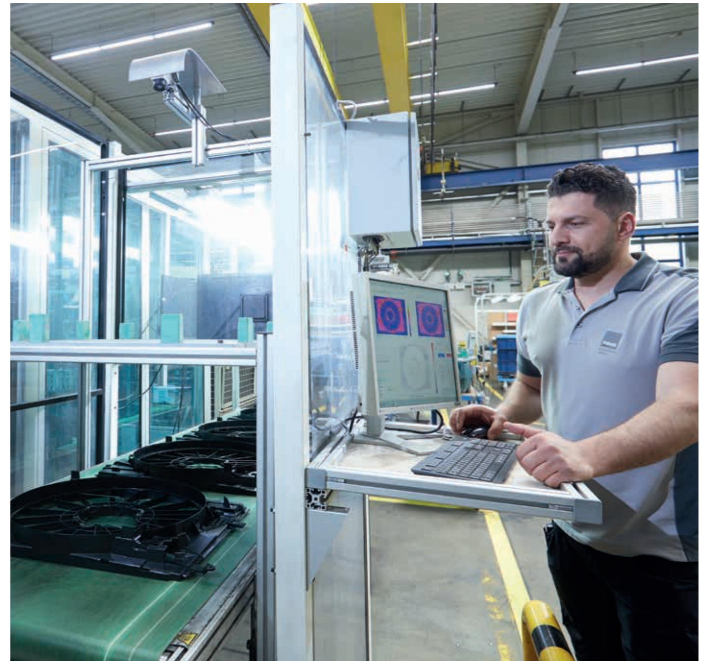
Qualitätssicherung mittels Infrarotkameras – unverzichtbar im Produktionsprozess.
